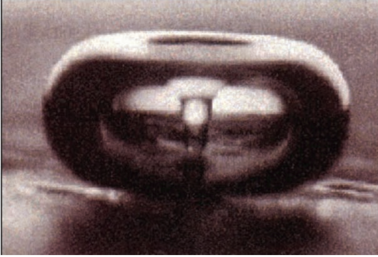
Şekil 7 • Dornier HM3'ten çıkan şok dalgasına maruz kalmış silindirik (14 mm çap) şeffaf bir taşta oluşan stres dalgaları. A: 178 µsn'de aşağıdan yukarıya doğru ilerleyen şok dalgası taşın alt yüzeyine çarpıyor. B: 184 µsn'de şok dalgası taşta nüfuz etmiş ve aynı zamanda geri yansıtılmış. C: 186 µsn'de şok dalgasının kompresif fazı taşın distal yüzeyini etkilemiş ve taşın orta noktasında bir makaslama (shear) dalgası belirmiştir (8).
